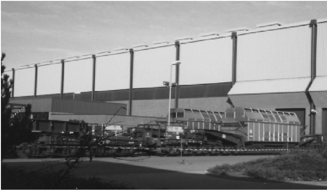
Die sogenannten Castoren, die Spezial-Transportwaggons für Kernbrennstäbe verlassen die Ladehalle auf dem Werksgelände. Foto: Gesellschaft für Nuklear-Service mbH
