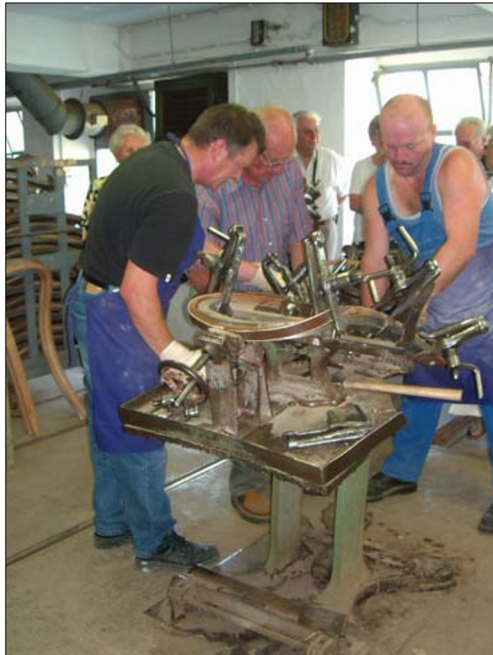
Im Thonet-Werk: In der Biegerei hilft VDI-Mitglied Manfred Schneider beim Einspannen des feuchtheißen Holzstabes in die Stahlform.
