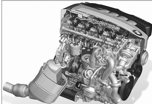
Heute High-Tech: BMW-Vierzylinder-Dieselmotor mit Common-Rail-Einspritzung und variablen Twin-Turbo
