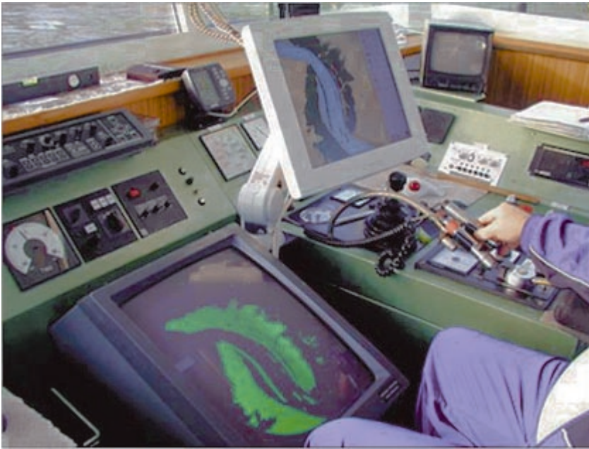
Auf dem Rhein am Steuerstand der MS Mainz: Der Kapitän hat das elektronische Fahrrinnen-Informationssystem ARGO im Blick.
