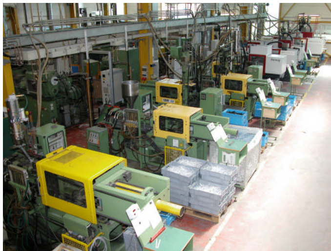
Moderne Fertigung: Spritzgießmaschinen stellen Teile aus Kunststoff für die elektrischen Bauelemente her.
