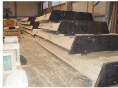
Für das erste Projekt: Untere Bauelemente mit Stahl Sonderbauteilen für die Befestigung am Fundament Bild: TimberTower
