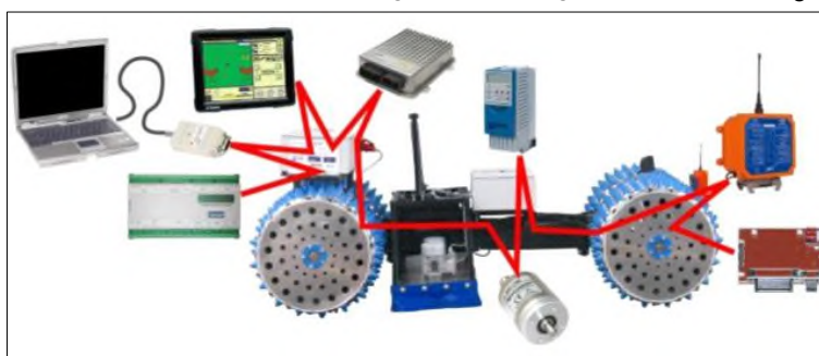
Bild 5 Modernes Steuerungskonzept: Über den Fahrzeug CAN-Bus können alle Funktionen gesteuert werden und alle Daten und Informationen abgerufen werden. Das Bild zeigt die angeschlossenen Komponenten.
