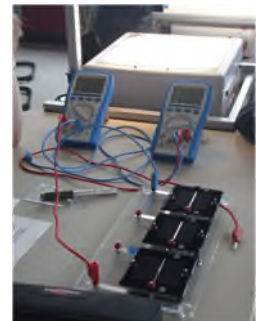
Strom- und Spannungsmessung
