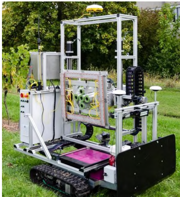
Bild 4 Gesamtaufbau des „PHENObot: Elektrisch angetriebene Laufwerke sorgen für eine große Laufruhe und damit für eine sichere Funktion des Kamerasystems (Bildmitte).
