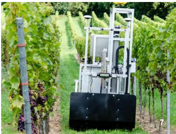
Bild 6 „Geisi“ - Ein echtes Multifunktionsfahrzeug durch Aufbaumodule: Für Mulcharbeiten (links oben), Pflanzenschutz (rechts oben) und Transport (unten)
