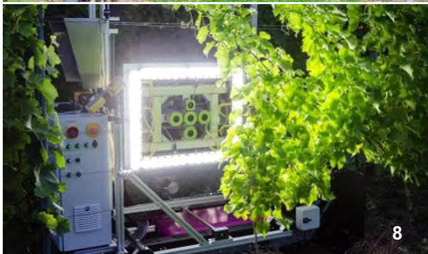
Bild 7 PHENObot im Einsatz auf einem leicht geneigten Hang: Das Kamerasystem wird sensorgesteuert senkrecht ausgerichtet.
