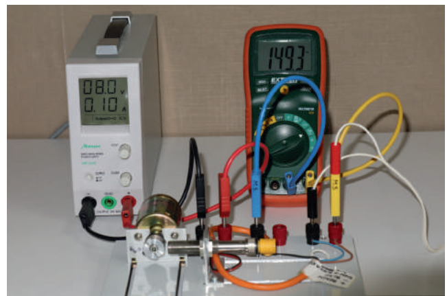
Drehzahlmessung an einem Elektromotor mit Hilfe eines induktiven Gebers
