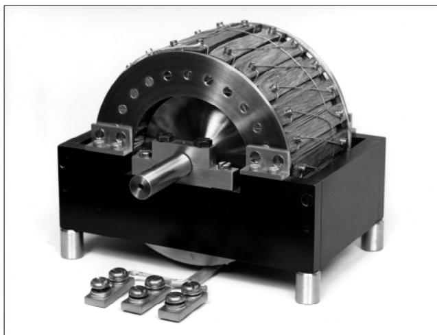
Bild 3 Damals: Erster Dreiphasen-Wechselstrommotor von Michael Dolivo-Dobrowolsky 1889.
