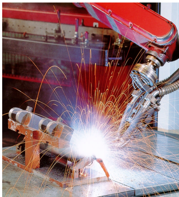
Schweißroboter: Hohe Leistung und geringer Verzug der Bauteile durch präzise Schweißnähte kennzeichnen die Arbeit eines Schweißroboters
