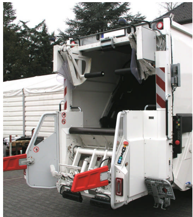
Ein klassisches Produkt: Ein hydraulischer Lifter System 2405 als vormontierte Einheit (links), ... am Fahrzeug montiert (rechts). 1 Klappprutsche, 2 klappbare Sicherheitsschranke, 3 Deckelöffnerkurven, 4 Aufnahmekamm
