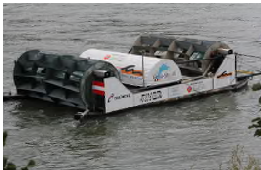
Bild 4 Der River Rider bei Niederheimbach: Die Stadtwerke Mainz und die Mainova wollen die Anlage zwei Jahre lang testen. Leistung 4,5 kW.
