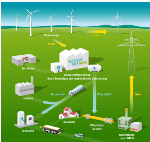
Im Energiepark Mainz verwirklicht: In der 6-Megawatt-Anlage wird aus Windenergie durch Elektrolyse Wasserstoff erzeugt, der unmittelbar verbraucht, gespeichert und später wieder „rückverstromt“ werden kann. Grafik: SW Mainz
