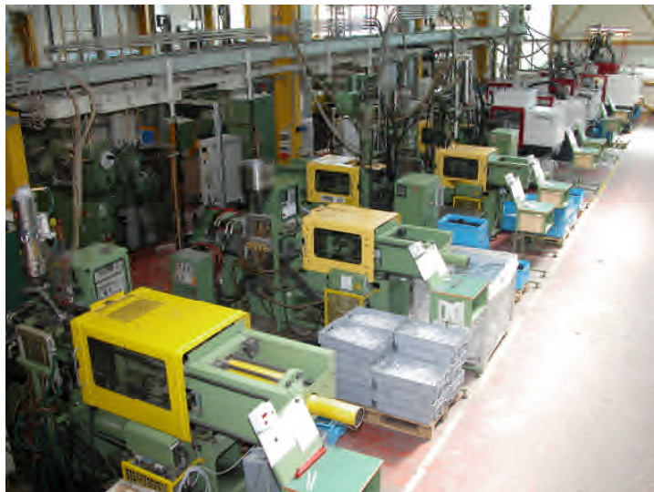
Beeindruckend für Schüler und Lehrer: Spritzgießmaschinen in der Produktion, hier bei JEAN MÜLLER, Elville, stellen Kunststoffteile für elektrische Bauelemente her. Bild: Jean Müller
