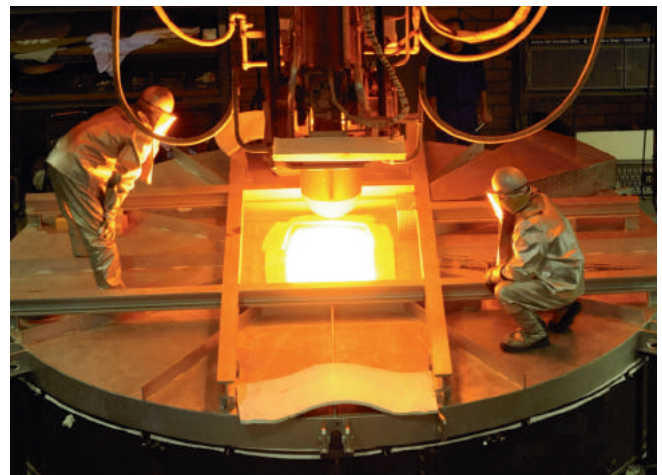
Beim Guss eines Spiegelträgers läuft über 1000 °C heißes Glas in die Form
